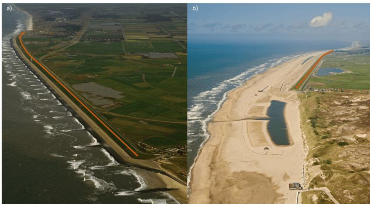
Figura 9. Dique marítimo de Hondsbossche (línea naranja) antes y después del abastecimiento de arena
