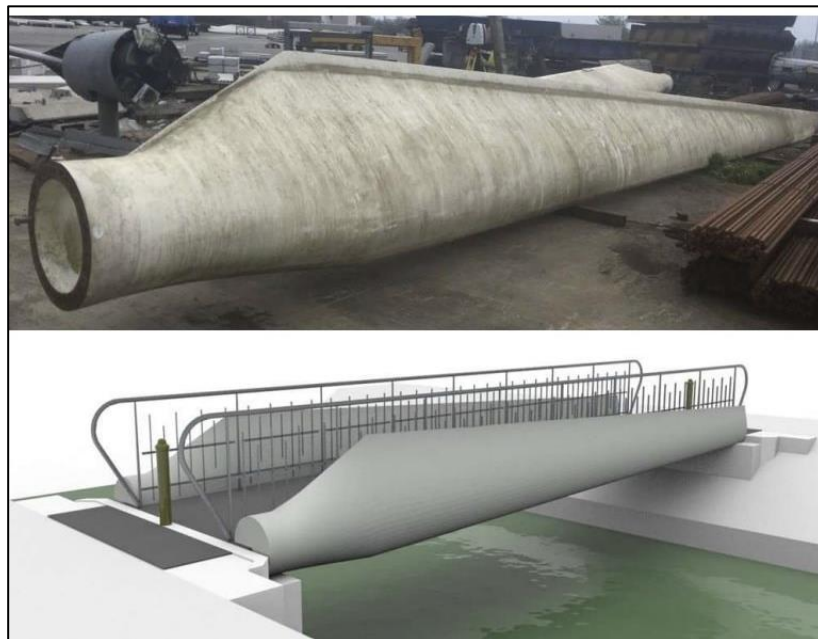
Imagen 5 Reutilización de pala eólica para construcción de puentes Fuente: CDT, 2022.
