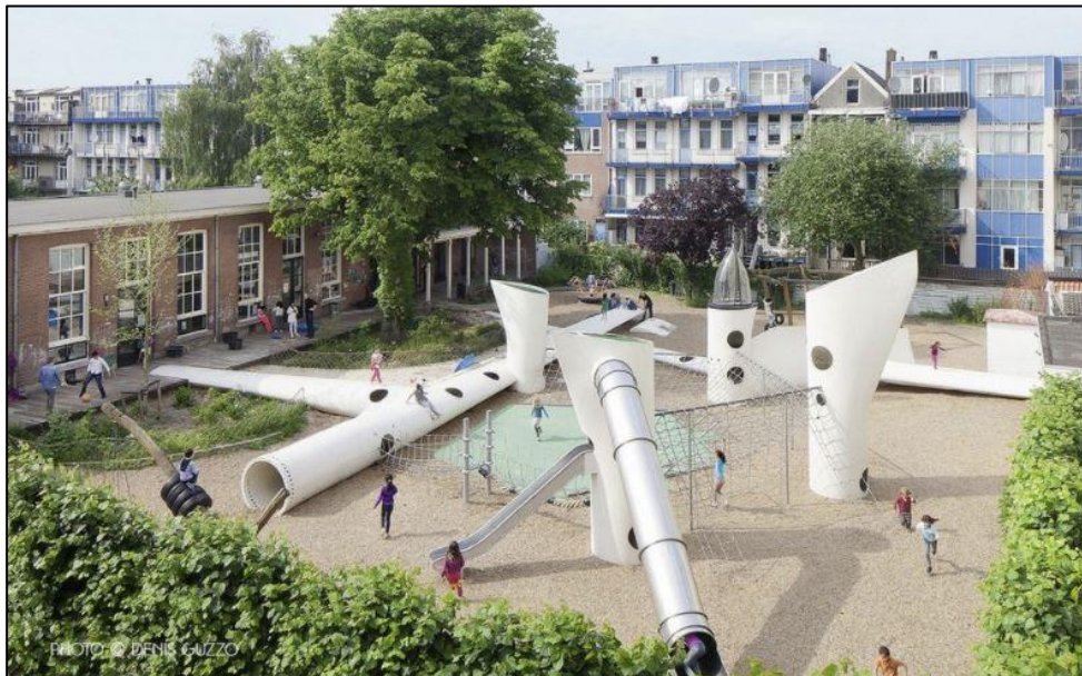
Imagen 7 Palas eólicas reutilizadas para mobiliario urbano para patio de colegio en Holanda en Rotterdam. Fuente: CDT, 2022.
