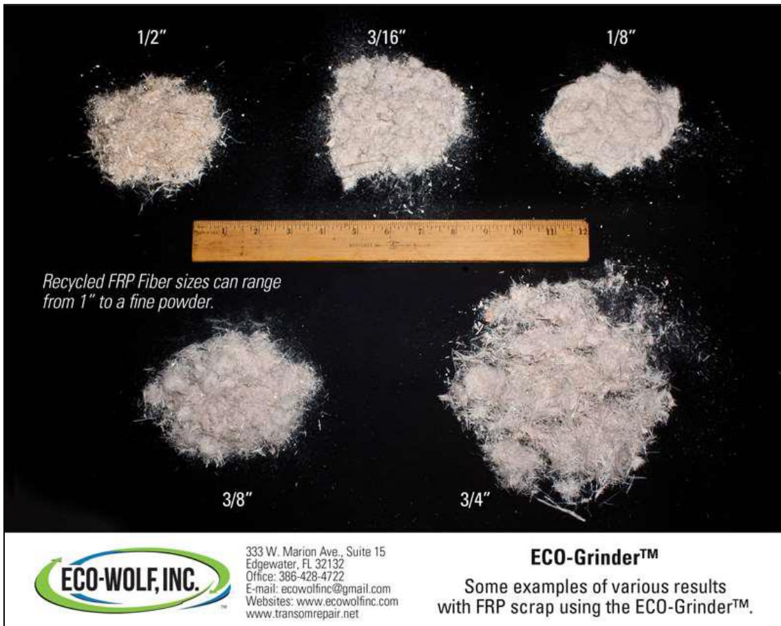
Imagen 10 Fibras recuperadas mediante molienda para hormigón Fuente: C. Bank, 2018.
